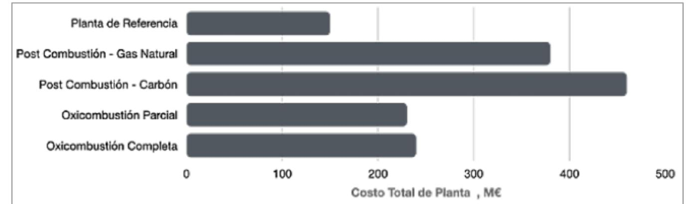
Figura 5. Costos comparativos de inversión de una planta de captura de CO<sub>2</sub> en dos tecnologías (M€) para una planta de cemento de aproximadamente 1.36 Mt cemento/año [1].
